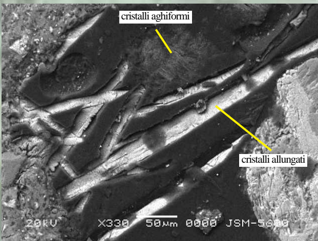
La Backscattered electron image (BEI) mostra cristalli allungati e cristalli aghiformi di struttura finissima nella fessurazione
