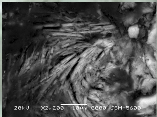
Alto ingrandimento della vista dei cristalli aghiformi nella fessurazione
